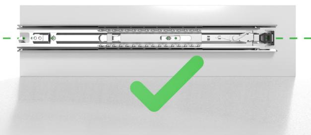
Außenschiene muss parallel zum Boden verlaufen.
