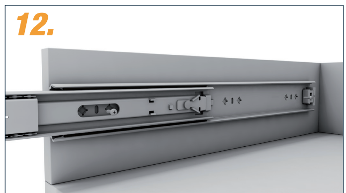
Außenschiene kann mit Schrauben in den Langlöchern fixiert und noch ausgerichtet werden. z.B. mit Rundkopfschraube 4mm (nicht im Lieferumfang). Schrauben können nach der Montage optional wieder entfernt werden.
