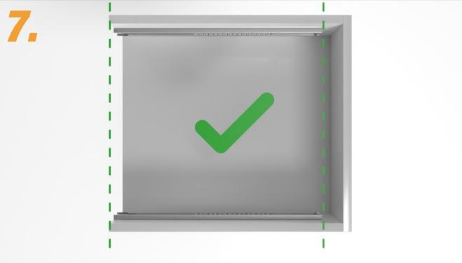
Außenschiene müssen vorne bündig und parallel verlaufen.
