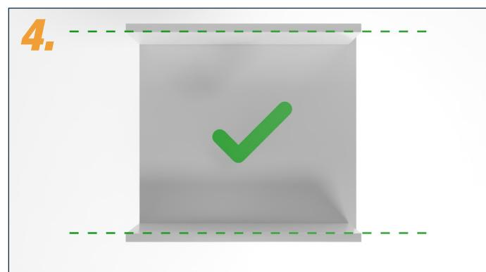
Seitenwände vom Schrankkörper müssen parallel sein.
