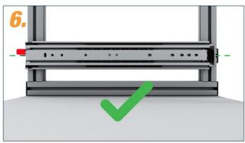
Außenschiene muss parallel zum Boden verlaufen.
