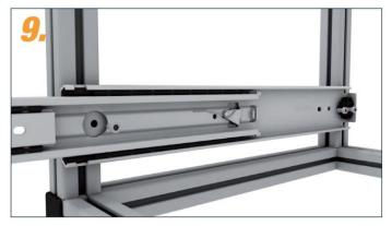
Außenschiene mit Schrauben befestigen. Bei Metall-Korpus z.B. mit Zylinderkopfschraube DIN 6912 M5/ M6x10, bei Holz-Korpus z.B. mit Euroschraube 6,3x16 oder Senkschraube 4x16 (nicht im Lieferumfang).
