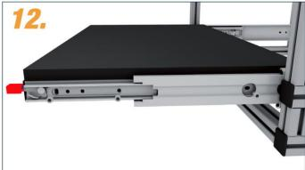
Innenschiene mit Schrauben befestigen. Bei Metall-Korpus z.B. mit Zylinderkopfschraube DIN 6912 M5/ M6x10, bei Holz-Korpus z.B. mit Euroschraube 6,3x16 oder Senkschraube 4x16 (nicht im Lieferumfang).
