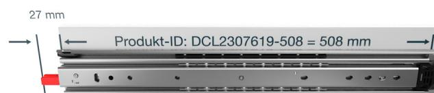
Einbaulänge gemäß Produktbeschreibung zzgl. 27mm Entriegelungshebel. Bei Verwendung der Einhandverriegelung werden 47mm an Platz benötigt.
