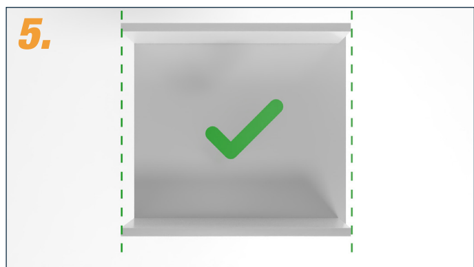
Seitenwände vom Schrankkorpus müssen vorne bündig sein.
