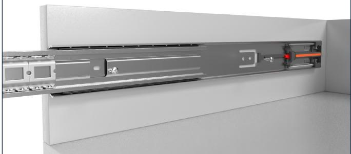
Außenschiene kann mit Schrauben in den Langlöchern fixiert und noch ausgerichtet werden. z.B. mit Rundkopfschraube 4mm (nicht im Lieferumfang). Schrauben können nach der Montage optional wieder entfernt werden.
