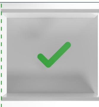
Seitenwände vom Schrankkörper müssen vorne bündig
